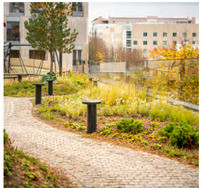
Monilajiset istutusalueet reunustavat kattopuutarhassa polveilevia kulkureittejä. Istutusten ja kulkupintojen välistä rajaa on pehmennetty kiven pintakäsittelyä vaihtamalla. Kuva: Mika Huisman/Decopic.
