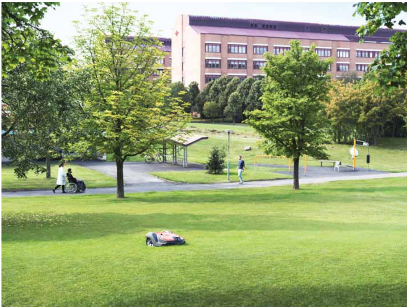
Sensoreillaan robotti tunnistaa esteen, kuten ihmisen tai koiran. Se hidastaa ja vaihtaa kulkusuuntaa. Kulkuväylän ylityskohtaan on syytä laittaa varoituskyltti. On suositeltavaa kertoa alueen käyttäjille, että aluetta hoitaa robotti.
