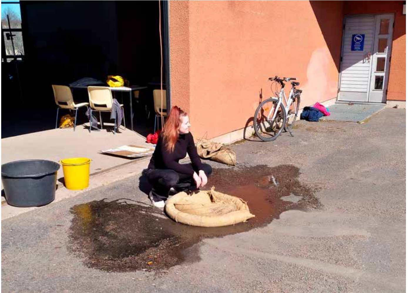
Hortonomiopiskelija Tuulia Kalliokoski esittelee hulevesikaivon ympärille asennettavaa "kiintoainesiepparin" prototyyppiä.
