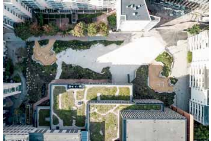
Kaapelipuisto ja kasvikatto. Tanstin talon toteutetulla monitasoisella kasvikatolla on huomattava merkitys muun muassa hulevesien viivytykselle tontilla. Kuva: Lotta Pulkkinen
