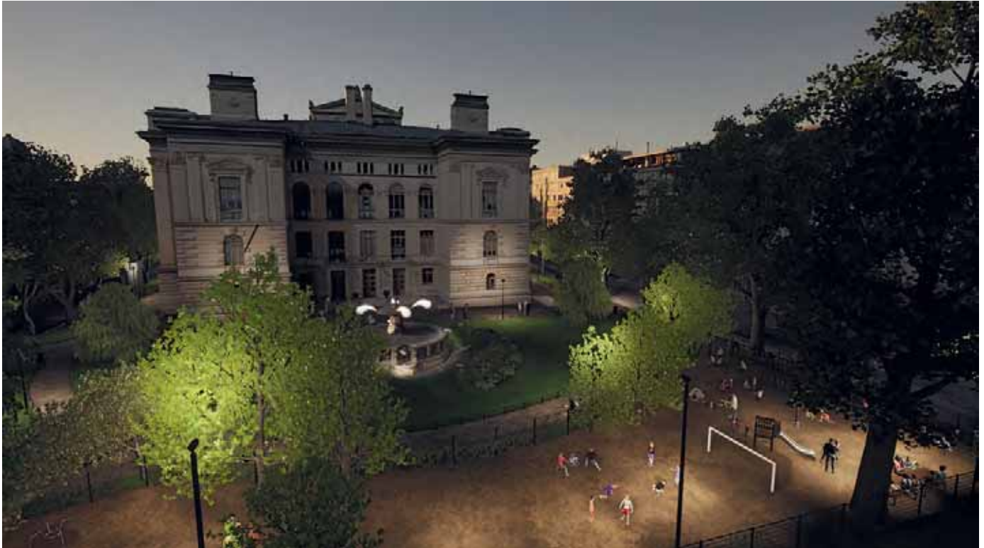
Helsingin Säätytalonpuistikon leikkialueen valaistus suunniteltiin erilliseksi muun puiston valaistuksesta. Valaistus ohjelmoidaan ajastetuksi niin, että se kirkastuu leikkipaikan käyttöaikoina ja muina aikoina himmenee ympäristöön paremmin sopivaksi.
